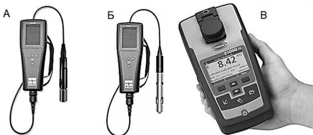
Рис. 4. Примеры приборов для измерения удельной электропроводности (А), водородного показателя и температуры воды (Б) и мутности воды (В)
